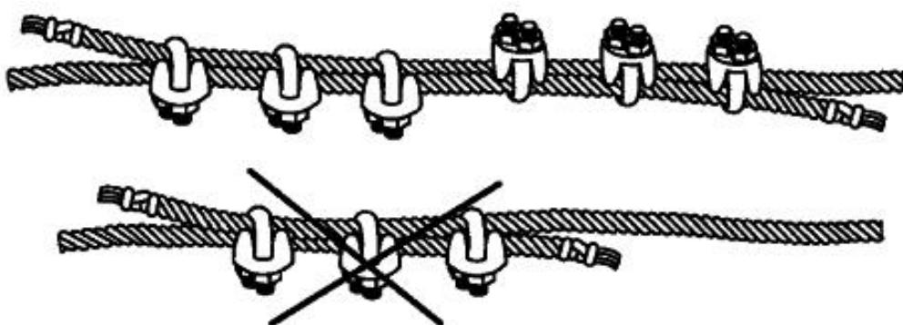
a) Правильное и неправильное расположение зажимов каната при параллельном подсоединении концов каната
