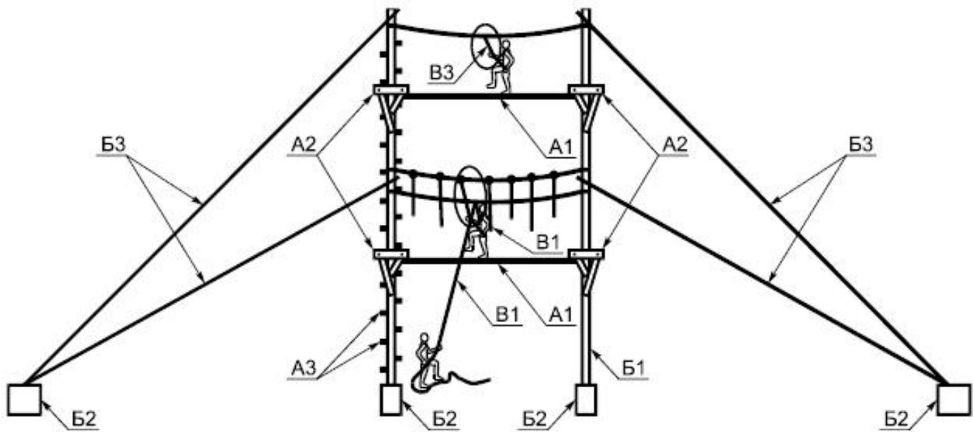
А - рабочие системы: А1 - элементы, А2 - платформы, А3 - лестницы; Б - опорные системы: Б1 - опоры (чурбаки, булыжники, иные опорные конструкции), Б2 - фундаменты, анкеры, Б3 - оттяжки; В - страховочные линии: В1 - страховочная линия с ассистентом, В3 - самостраховка
